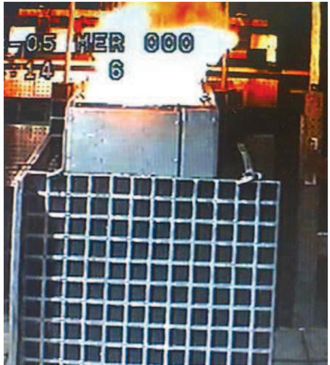
Il fotogramma mostra l'istante in cui i gas roventi generati dall'innesco dell'arco elettrico, fuoriescono attraverso appositi condotti che li dirigono verso gli appositi flap posizionati sul tetto e che vengono aperti automaticamente dalla sovrappressione generata all'interno del quadro stesso.
