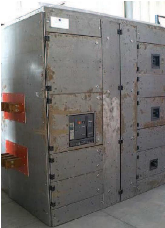
Vista frontale del prototipo sottoposto alle prove di tenuta all'arco interno. Sono ben visibili le cerniere di tipo rinforzato, i doppi punti di chiusura delle portelle, oltre ai 14 punti di fissaggio delle pannellature laterali, necessari a garantire una buona tenuta in caso di sovrappressione interna dovuta all'innesco di un arco elettrico.
