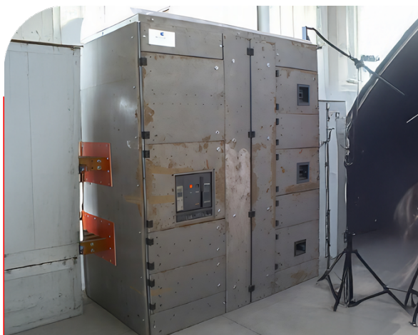
Vista frontale del prototipo sottoposto alle prove di tenuta all'arco interno e fotogramma relativo all'innesco dell'arco. Vous voyez le devant du prototype soumis aux preuves d'étanchéité de l'arc interne et image de déclenchement d'arc Front prototype view submitted to the tests referred to the capacity of the internal arc and the arc trigger frame
