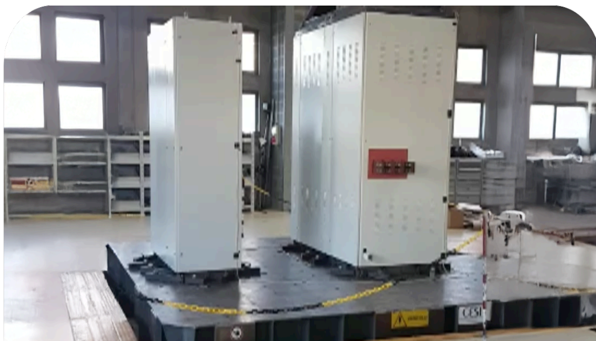
Prototipi montati su tavola vibrante in fase di test - Prototypes montés sur table vibrante en phase d'essai Prototypes mounted on vibrating table under test.
